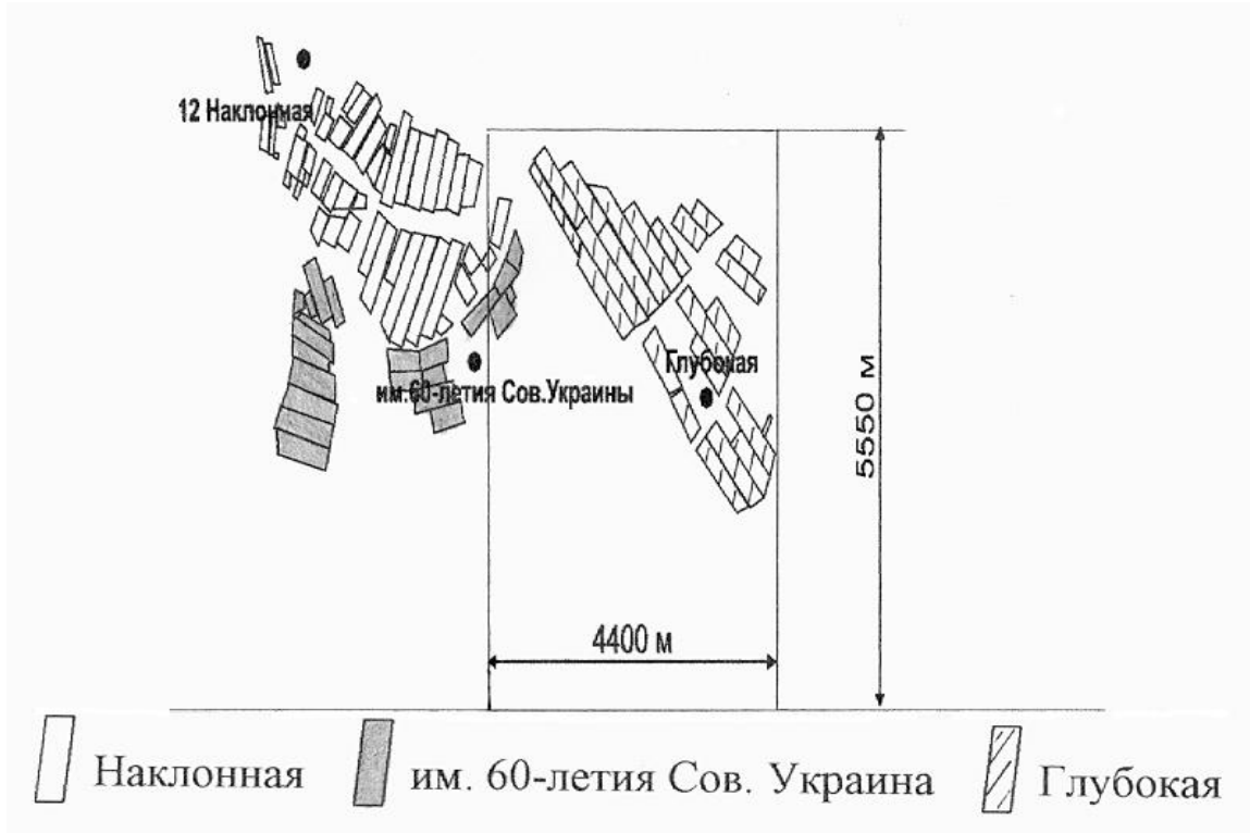
Рис. 5. Схемы расположения выработок по пласту h_4
