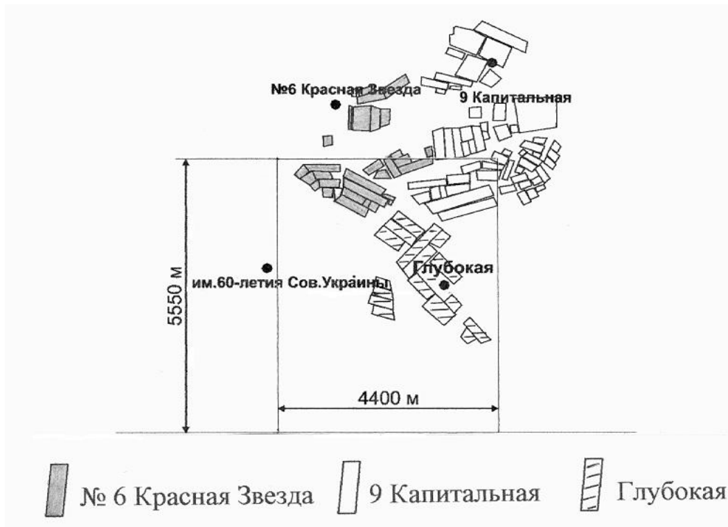
Рис. 4. Схемы расположения выработок по пласту h_6
