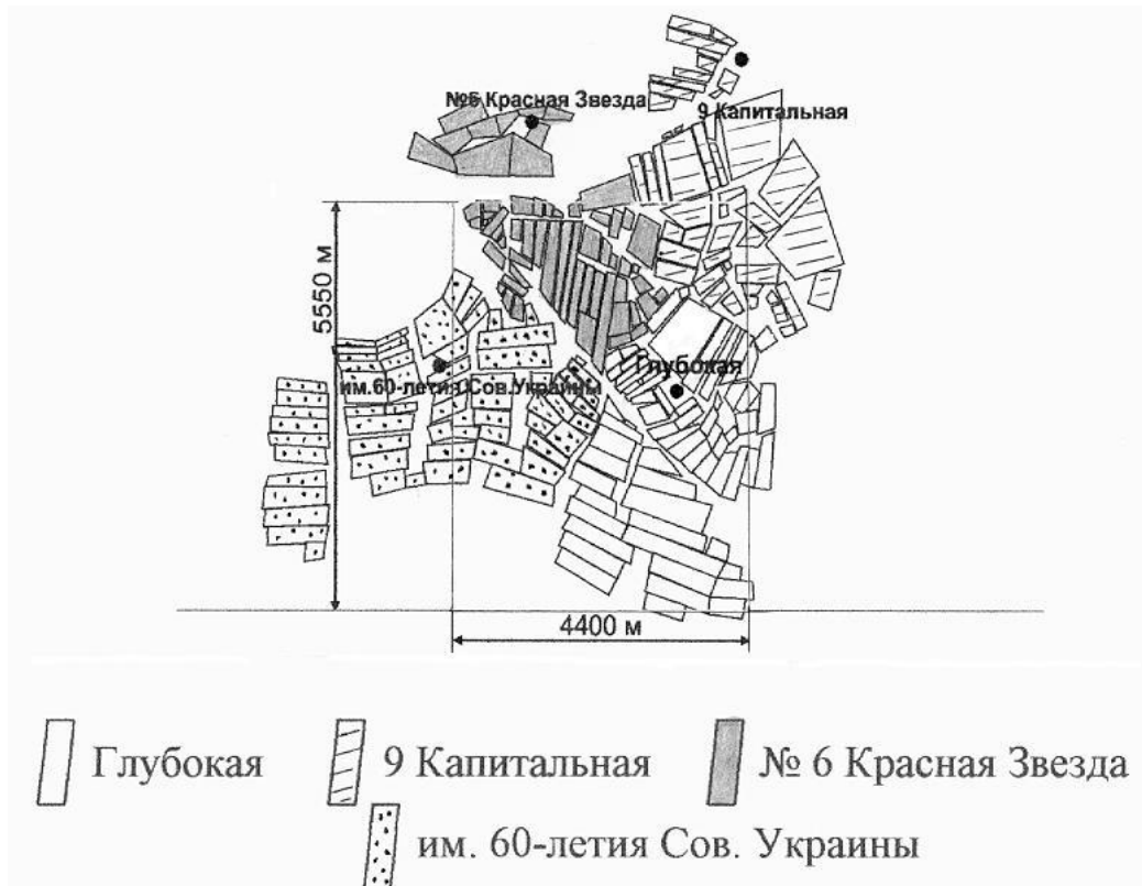
Рис. 1. Схемы расположения выработок по пласту h_{10}
