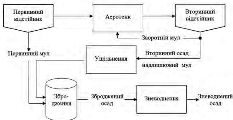
Рис.1. Типова схема традиційної технології переробки осадів міських стічних вод та види осадів у процесі переробки.
