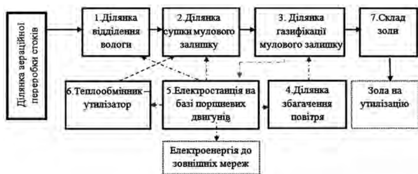
Рис.7. Технологічна схема заводу утилізації мулу повітряно-кисневою газифікацією з виробництвом електроенергії у двигуні внутрішнього згорання.
