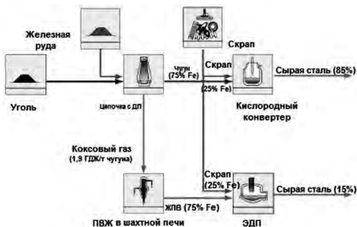
Рис.6. Использование коксового газа для ПВЖ на интегрированном металлургическом заводе.
