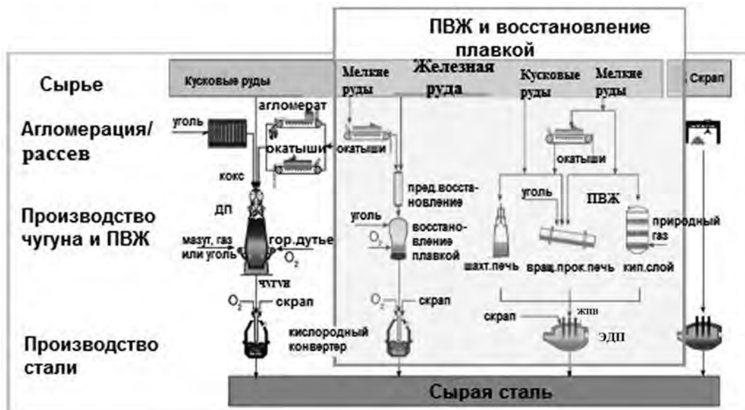
Рис.2. Схема производства сырой стали.
