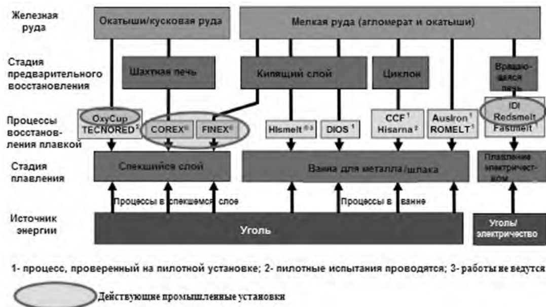
Рис.4. Классификация процессов восстановления железа плавкой.
