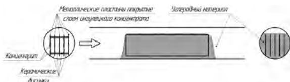
Рис. 2. Пакет из металлических пластин с нанесенным на них железным катализатором.
