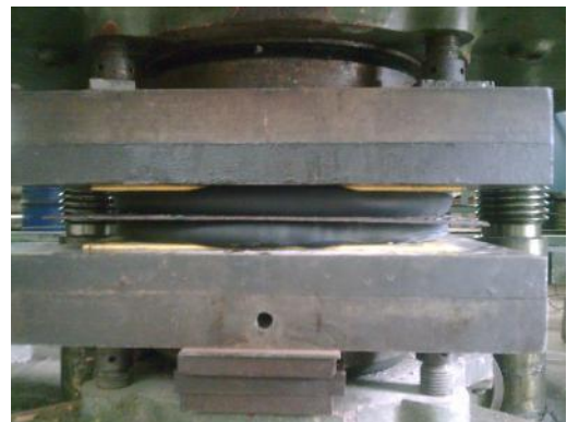
Рисунок 4 – Общий вид ЭБ диаметром 500 мм под нагрузкой 3000 кН
