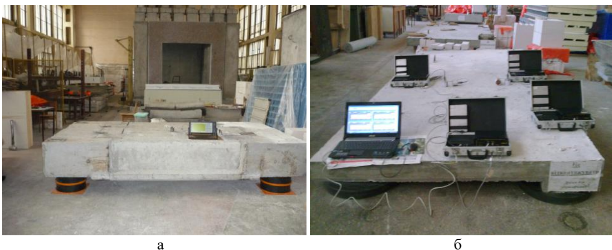
Рисунок 2 – Лабораторные динамические испытания эластомерных блоков
