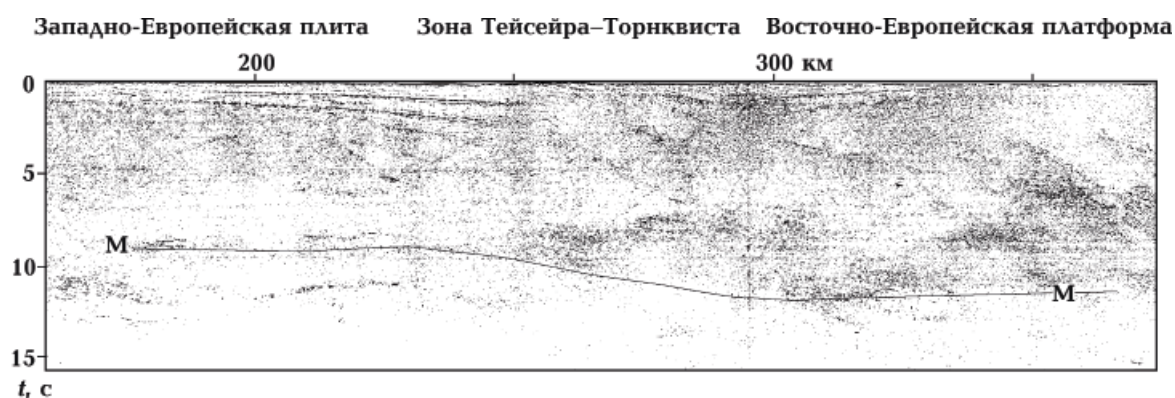
Рис. 2. Временной разрез ОГТ по профилю BABEL-A, секущему переходную зону между Балтийским щитом и Западно-Европейской плитой и зону Тейсейра—Торнквиста [BABEL, 1993].
