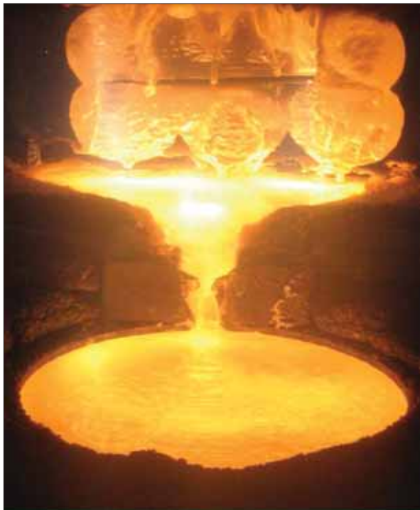
Рис. 2. Процес плавлення з губчастого титану зливка діаметром 600 мм
