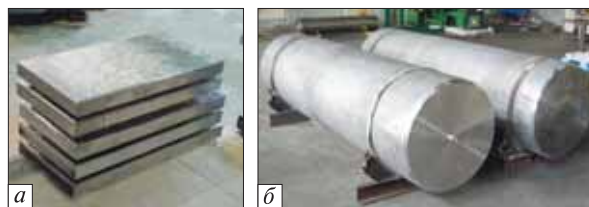
Рис. 8. Зливки-сляби: а – титанового сплаву морського призначення ПТ7М; б – жароміцного титанового сплаву BT3-1 діаметром 840 мм та довжиною 3000 мм
