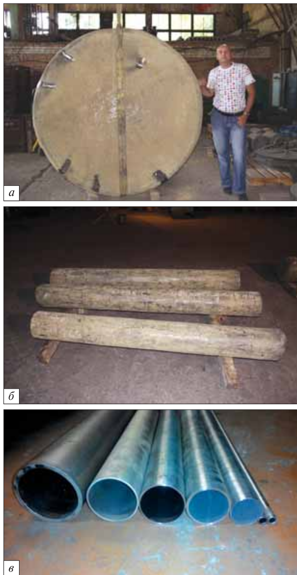
Рис. 9. Напівфабрикати з титанових сплавів, виготовлених зі зливків, отриманих методом електронно-променевої плавки: a – поковка 1950×160 мм з жароміцного титанового сплаву ВТЗ-1; б – ковани прутки з титанового сплаву ВТ14; в – холоднокатані труби з титанового сплаву ПТ7М різного сортаменту
