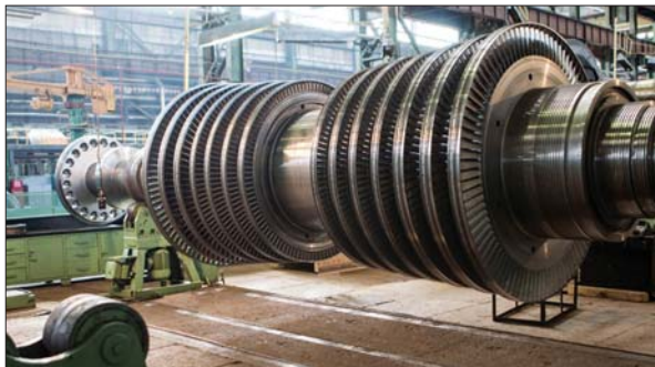
Зварно-кований ротор високого тиску турбіни К-1000-60/1500-2 з модернізованою протоковою частиною
