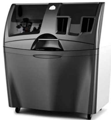
Рис. 3. Устаткування (Pro Jet 360) для 3D-друку розпиленням розчину полімеру на шар керамічного порошку
