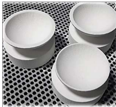
Рис. 4. Напівфабрикати, надруковані з оптично прозорою керамікою до відпалу
