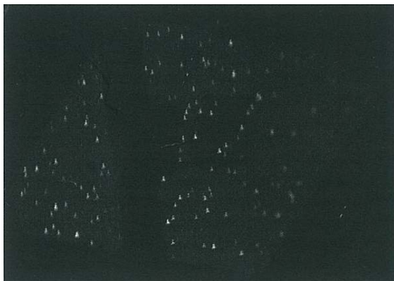
Рис. 4. Мікроплазмове світіння зворотньозмщеного GaP-світлодіода
