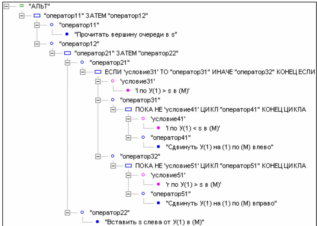
Рис. 1. Дерево конструювання для складеного оператора АЛБТ, побудоване в ДСП-конструкторі
