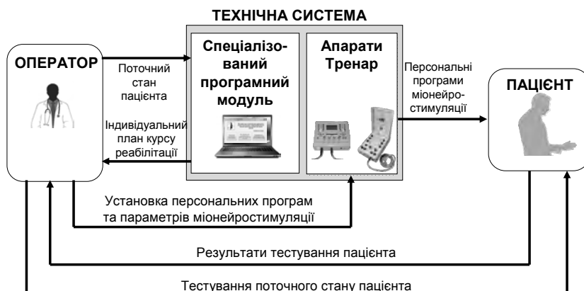
Рис. 8. Структурно-функціональна модель комп'ютерного програмно-апаратного комплексу персонального відновлення мовлення «ПРОМОВА-1»
