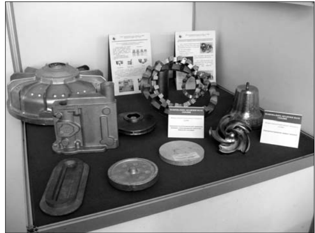
Рис. 2. Виливки, одержані за інноваційними технологіями лиття: електронно-променевими ливарними технологіями, технологією одержання виливків з розосередженою ливниково-живлячою системою, лиття під низьким тиском з газовим та поршневим допресуванням
