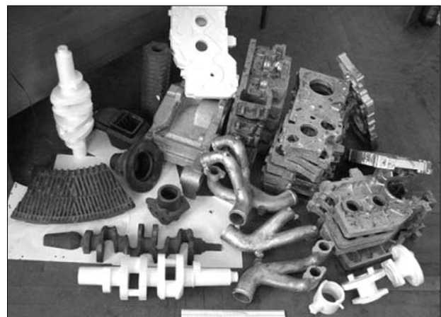
Рис. 1. Виливки, одержані за технологією лиття за моделями, що газифікуються (ЛГМ)
