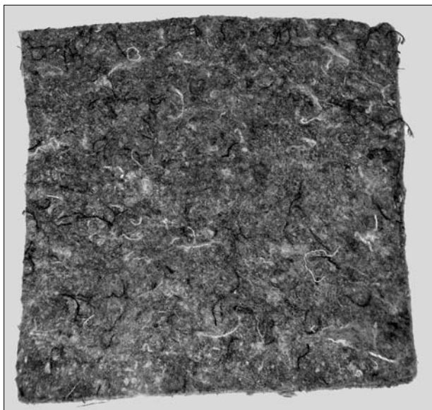
Рис. 5. НВЧ-поглинаючі звуко- і теплоізоляційні матеріали
