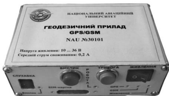
Рис. 5. Макетний зразок одночастотного приймача, розроблений в НАУ
