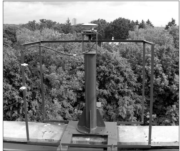
Рис. 2. Антена перманентної GPS/GNSS-станції GLSV (м. Київ, ГАО НАНУ)
