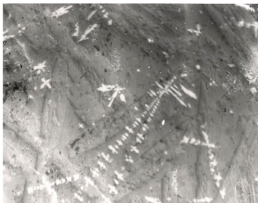
Рис. 16. Микроструктура керамики, полученной при высокой скорости охлаждения
