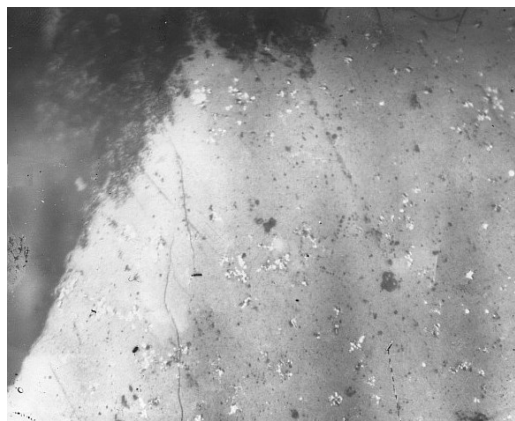
Рис. 13. Микроструктура керамики, полученной при 1650 °С
