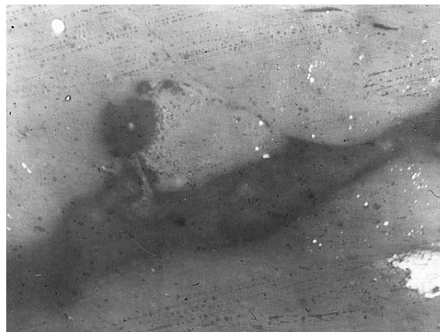
Рис. 6. Микроструктура керамики, полученной при 1650 °С
