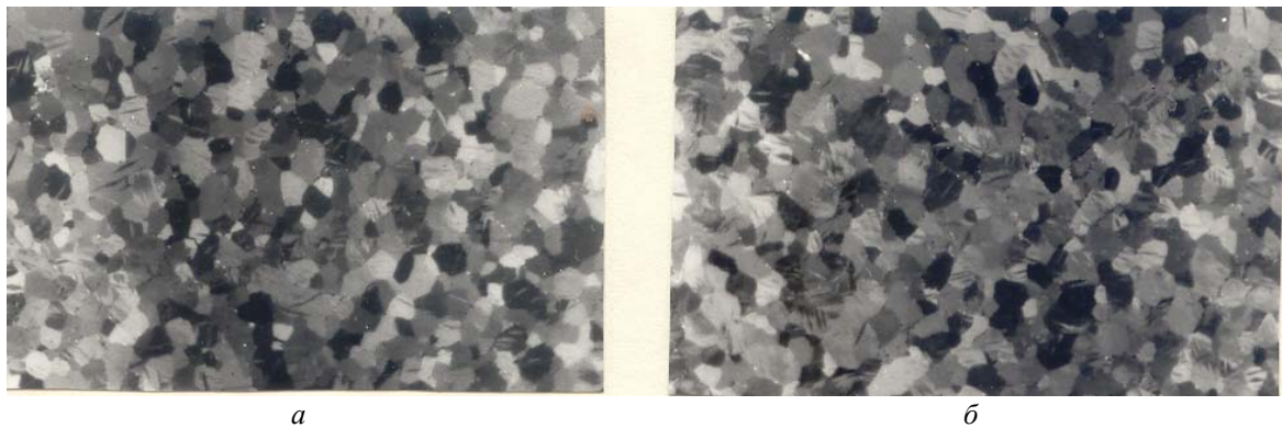
Рис. 1. Микроструктуры образцов материала с улучшенными характеристиками: долевая (а) и поперечная (б)
