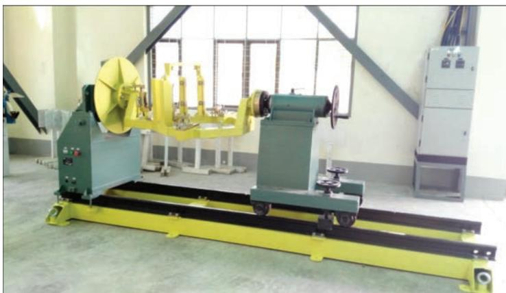
Установка для сборки и сварки навесных баков
