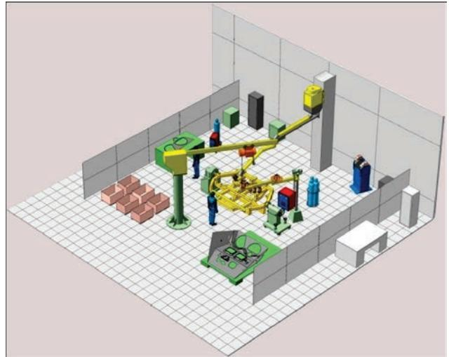
Пример сварочного участка для создания укрупненного узла сварного корпуса
