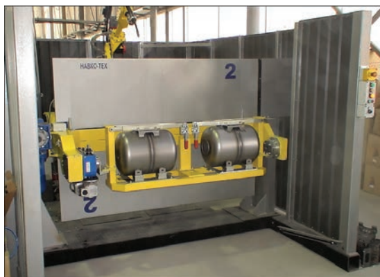
Рис. 5. Робототехнологический комплекс РК754 для МИГ-сварки кронштейнов и опор с баками гидроаккумуляторов
