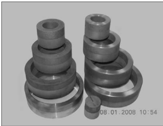
Рис. 5. Фото натурних виробів перехідникових елементів з'єднань трубопроводів АЕС
