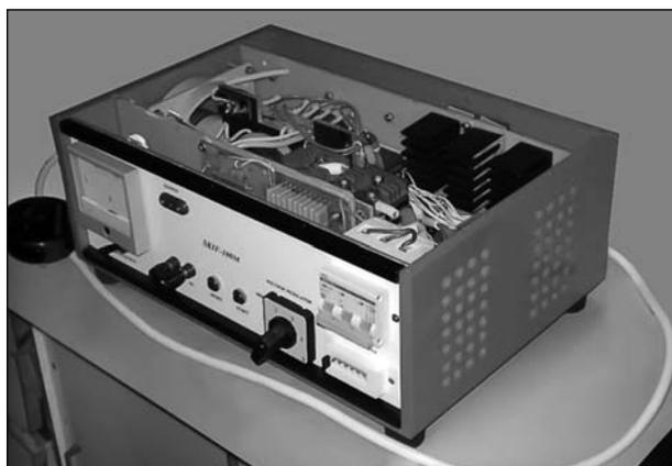
Рис. 4. Наземна частина (джерело живлення) електророзрядного поглиняного комплексу для інтенсифікації добування шахтного метану
