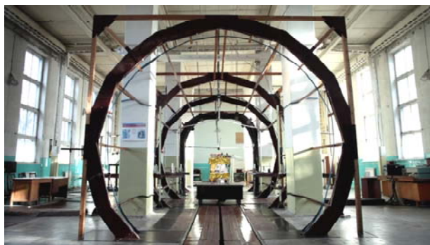
Рис. 7. Унікальний магнітовимірвальний стенд об'єкту національного надбання України «Магнітодинамічний комплекс» Інституту технічних проблем магнетизму НАН України (м. Харків.)
