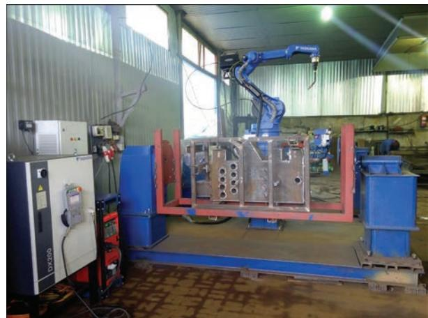
и устанавливать через USB-накопитель непосредственно в память контроллера. Также робот можно дооснастить комплектом для роботизированной сварки и он сможет выполнять две операции попеременно. Этот же робот можно поставить на трек или подвесить на портал, добавить манипулятор, использовать сменные столы, не привязываясь к размерам детали и ее статичному закреплению и перемещению лишь в заданной плоскости, что подтверждает универсальность применения роботов на производстве.
