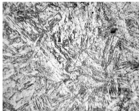
Рис. 2. Микроструктура металла лопатки после объемной термической обработки (увеличение  $\times 100$ )
