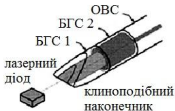
Рис. 1. Каскадне волокно, що містить клиноподібний наконечник + БГС 1 + БГС 2 + ОВС
