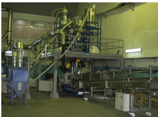
Рис. 1. Линия изготовления полиолефинов и ПВХ пластиков, в том числе не распространяющих горение и низкого газодымовыделения
