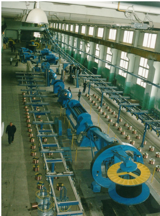
Рис. 3. Линия изготовления кабелей на напряжение 110 кВ (справа – вулканизационная труба, слева – линия общей скрутки жил в сердечник кабеля с помощью крутильной машины Drum twister)
