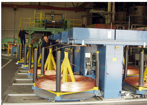
Рис. 2. Машина для изготовления медной бескислородной катанки путем вытягивания из расплава катодов (метод Upcast)
