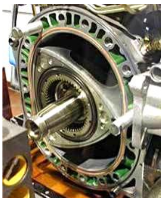
Рис. 16. Внешний вид роторно-поршневого двигателя Ванкеля с разобраным овальным цилиндром этого ДВС [15]
