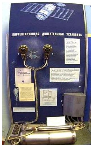
Рис. 31. Электроракетный ПД, созданный в 1971 году в Институте атомной энергии им. И.В. Курчатова (экспонат-установка политехнического музея, Москва) [27, 28]
