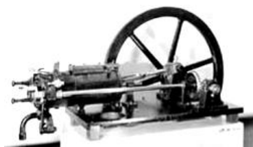
Рис. 5. Музейный экспонат первого четырехтактного ДВС известного немецкого инженера-механика Н.А. Отто [11]
