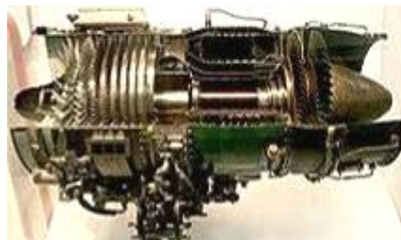
Рис. 20. Внешний вид американского турбореактивного двигателя типа GEJ85 (в продольном разрезе) производства компании "General Electric" (США) [23]
