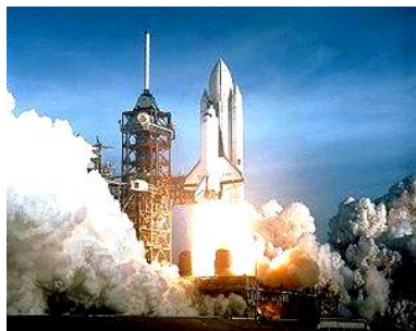
Рис. 27. Старт с космодрома многоразового космического корабля "Шаттл" с тягой ТТРД свыше 1300 тс (США) [24]
