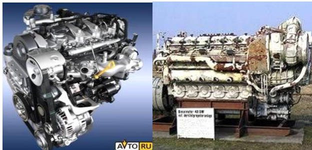
Рис. 14. Внешние виды автомобильного (слева без турбонаддува) и судового (справа с турбонаддувом) мощных дизельных двигателей разработки конца 20-го столетия [14, 15]
