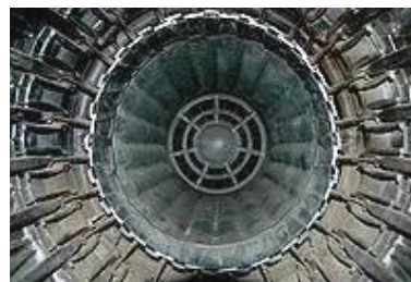
Рис. 21. Форсажная камера американского турбореактивного двигателя типа GEJ79 (вид со стороны сопла двигателя) производства компании "General Electric" (США) [23]
