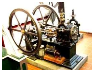
Рис. 3. Первый двухтактный ДВС известного бельгийского изобретателя Жан Этьен Ленуара (модель 1862 года) [9]
