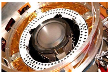
Рис. 34. Внешний вид современного американского ионного ракетного двигателя типа NSTAT, установленного в 1998 году NASA на космический зонд Deep Space 1 (США) [28]
