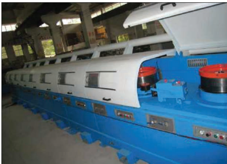
Линия для получения порошковых проволок для дуговой сварки, наплавки и термического напыления на лабораторно-технологической базе КУИС в г. Гуанчжоу, КНР
