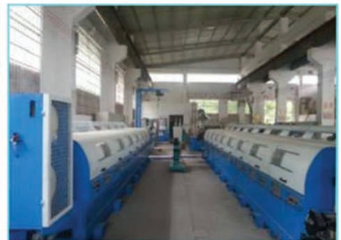
Линия для получения порошковых проволок для дуговой сварки, наплавки и термического напыления на лабораторно-технологической базе КУИС в г. Гуанчжоу, КНР
