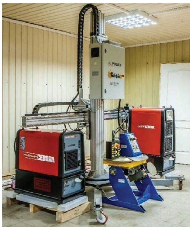
Инновационное универсальное оборудование для плазменной, гибридной и комбинированной («Плазма-МИГ» сварки, разработанное в ИЭС им. Е. О. Патона и поставленное на лабораторно-технологическую базу КУИС в г. Гуанчжоу, КНР
