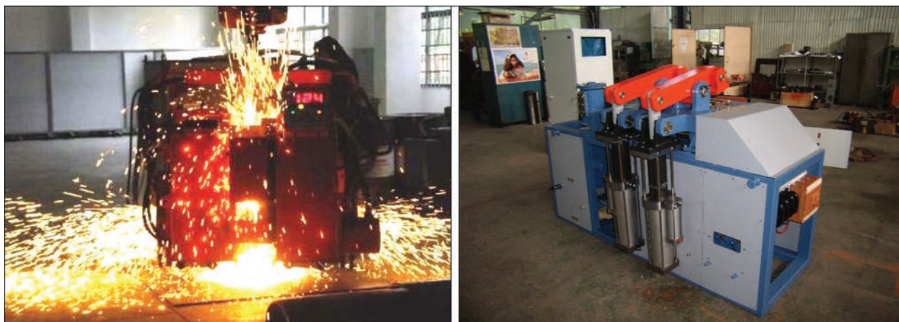
Оборудование для контактной стыковой сварки оплавлением, разработанное в ИЭС им. Е. О. Патона и поставленное на лабораторно-технологическую базу КУИС в г. Гуанчжоу, КНР
