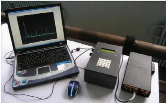
Низкочастотный дальнедействующий УЗК без сканирования поверхности протяженного (до 500 м) объекта
