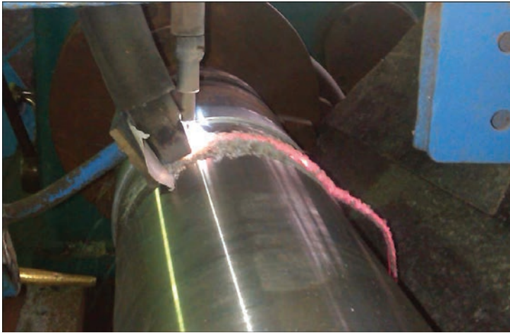
Рис. 1. Процесс наплавки штока
