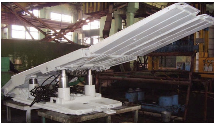
Рис. 2. Крепи механизированные после капитального ремонта
