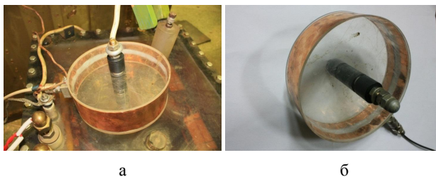
Рис. 7. Фото компактного ёмкостного делителя напряжения на 70 кВ с экранированным промежуточным электродом: а – делитель на изоляционной крышке высоковольтного импульсного трансформатора, б – делитель в сборе
