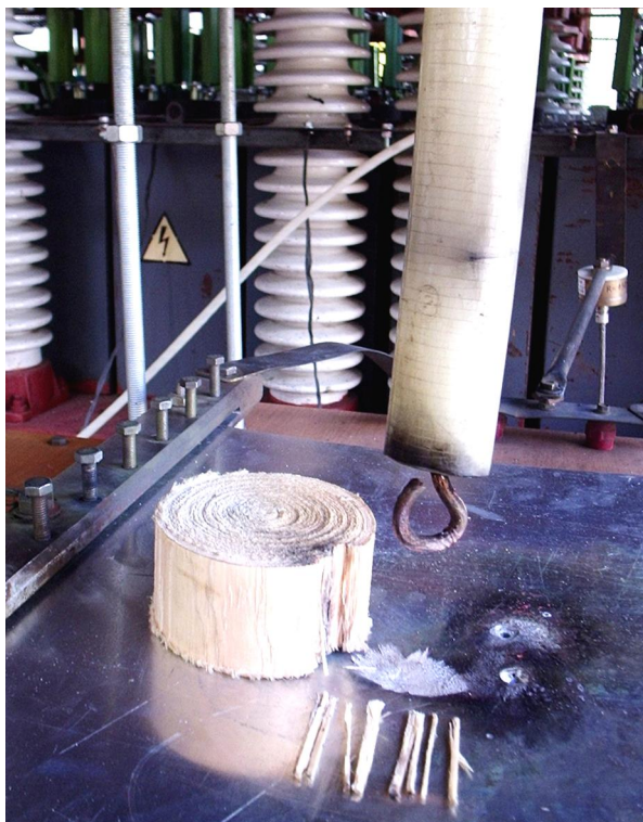
Рис. 5. Внешний вид нижней части ДЭС разрядной цепи высоковольтного генератора ГИТ-А, зоны разрушения и отдельных расколотых током молнии элементов опытного образца "живой" древесины сосны диаметром d_H=100 \text{ мм} и высотой h_H=50 \text{ мм} при U_{3A}=-10 \text{ кВ} и I_{mA}=65,7 \text{ кА}
