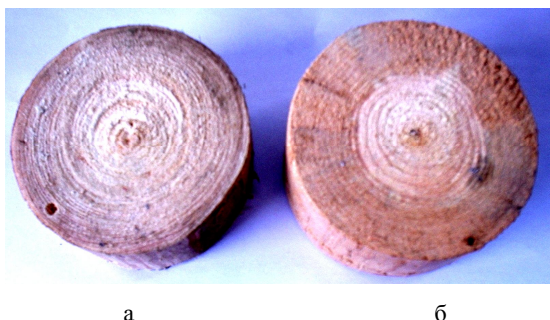
Рис. 3. Внешний вид испытываемых цилиндрических опытных образцов "живой" (слева – вид "а") и "мертвой" (справа – вид "б") древесины сосны наружным диаметром d_H=100 мм и высотой h_H=50 мм с круглым сквозным отверстием на их периферии (диаметром d_0=3 мм и длиной l_0=50 мм) под вертикальную установку в него тонкого медного ЭВП
