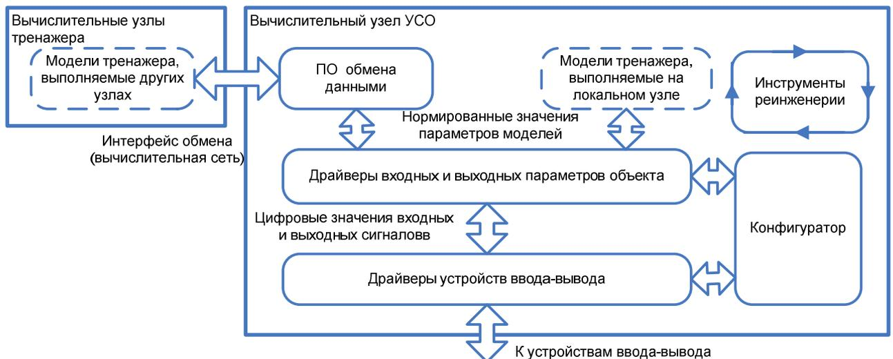
Рис. 5. Архитектура шаблона ПО УСО
