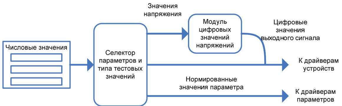
Рис. 17. Структура ПО генератора тестовых сигналов
