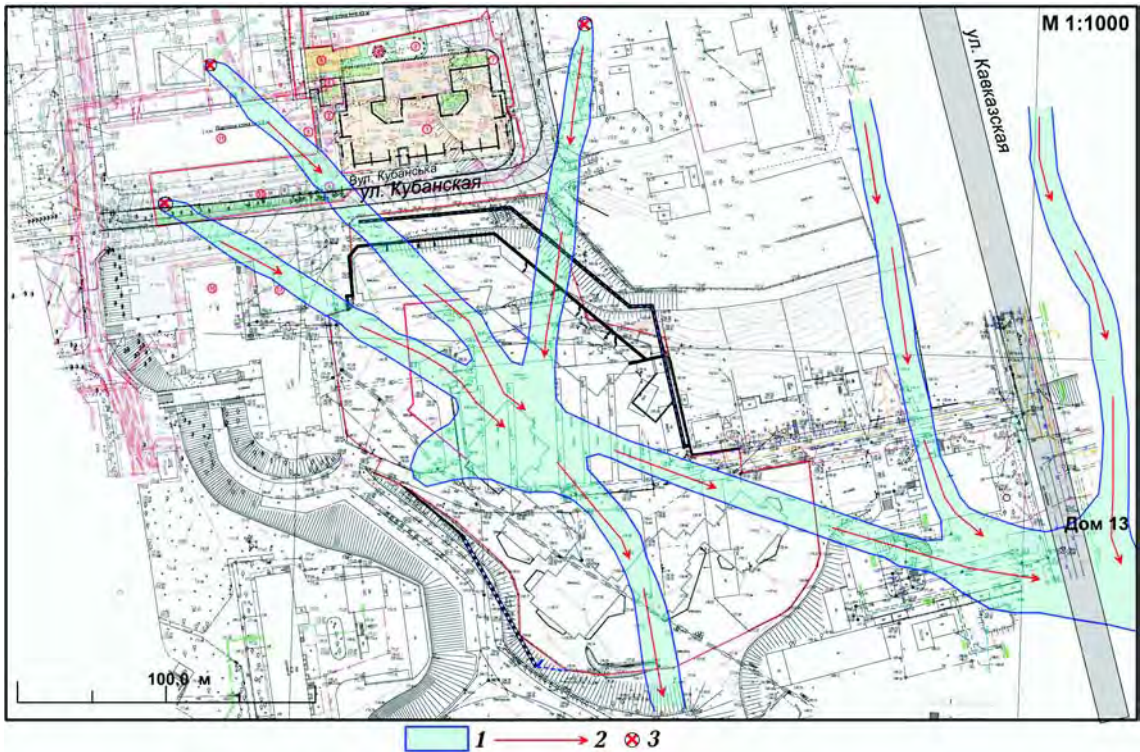
Рис. 7. Схема подземных водных потоков на плане участка строительства жилого комплекса по ул. В. Липковского 37г в Соломенском районе г. Киева: 1 — участки повышенного увлажнения грунтов; 2 — направления миграции грунтовых вод; 3 — места возможных утечек из подземных водных сетей.
