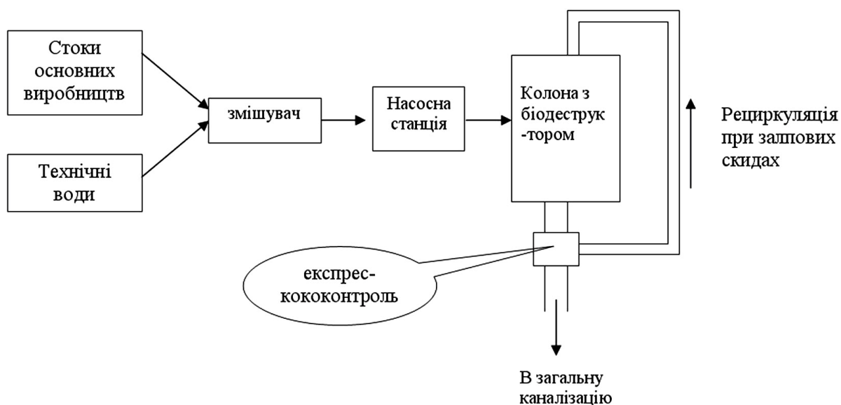
Рисунок 2 - Схема комплексу очисних споруд МПВ з використанням в якості активного компонента біодеструктора
