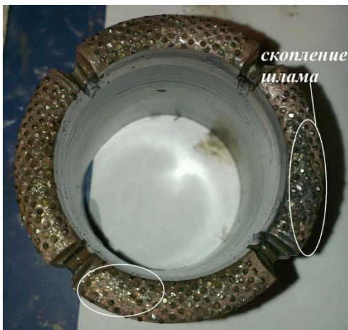
Рис. 1. Пример скопления илама на сбегающей части сектора коронки
