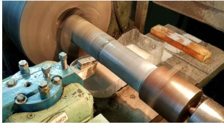
Рис. 1. Випробування на інтенсивність зношування на токарно-гвинторізному верстаті ФТ - 11
