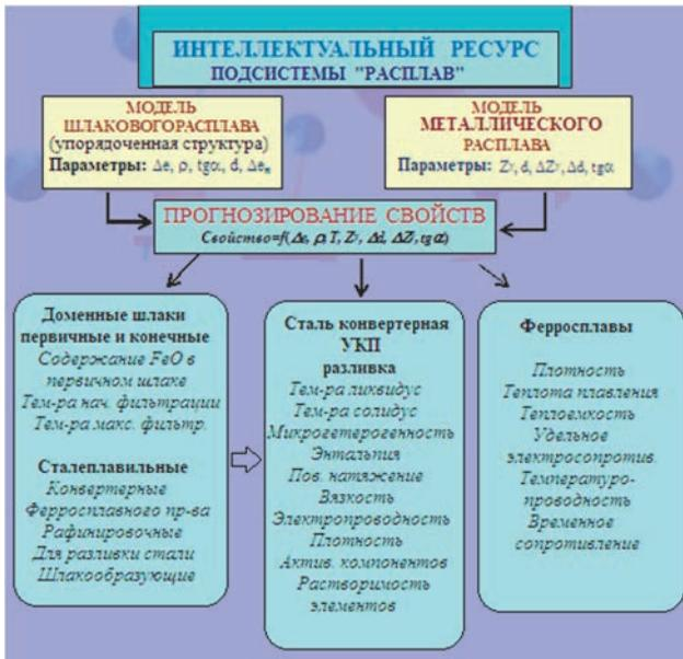
Рисунок 2 – Структурная схема модельной подсистемы «Расплав» БДМет
