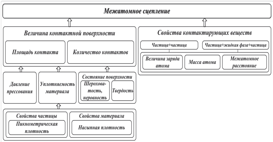
Рис. 6. Структура многофакторной модели формирования прочностных связей за счет межатомного и межмолекулярного сцепления
