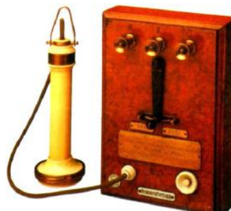
Рис. 22. Телефонный аппарат Белла конца 19-го века [13]
