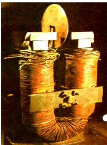
Рис. 16. Внешний вид исторического образца знаменитого "диска Фарадея" – первого в мире униполярного электрического генератора, хранящегося сейчас в музее Британского Королевского института (Англия) [6]
