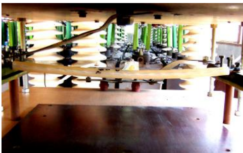
Рис. 13. Внешний вид рабочего стола ГТМ и испытываемого образца кабеля РК 75-17-31 с медной жилой сечением 10,2 \text{ мм}^2 в ПЭТ изоляции до совместного воздействия на него импульсной A - компоненты тока искусственной молнии с амплитудой I_{mA} = -205 \text{ кА} и длительной C - компоненты тока искусственной молнии с амплитудой I_{mC} = -0,914 \text{ кА}
