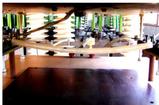
Рис. 14. Внешний вид рабочего стола ГТМ и испытываемого образца кабеля РК 75-17-31 с медной жилой сечением 10,2 \text{ мм}^2 в ПЭТ изоляции после совместного воздействия на него импульсной A - компоненты тока искусственной молнии с амплитудой I_{mA} = -205 \text{ кА} и длительной C - компоненты тока искусственной молнии с амплитудой I_{mC} = -0,914 \text{ кА}
