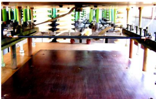
Рис. 18. Внешний вид рабочего стола ГТМ и испытываемого образца кабеля РК 75-4-11 с медной жилой сечением 0,407 \text{ мм}^2 до воздействия на него длительной C - компоненты тока искусственной молнии с амплитудой I_{mC} = -0,891 \text{ кА}
