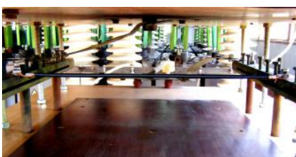
Рис. 3. Общий вид типового закрепления на рабочем столе ГТМ ИО проводов (кабелей) ЛА (сверху над центральной зоной образца, включенного в разрыв между горизонтально расположенными массивными алюминиевыми электродами, размещен круглый стальной электрод разрядных цепей ГТМ, соединенный плоской латунной шиной с одним из массивных алюминиевых электродов рабочего стола)
