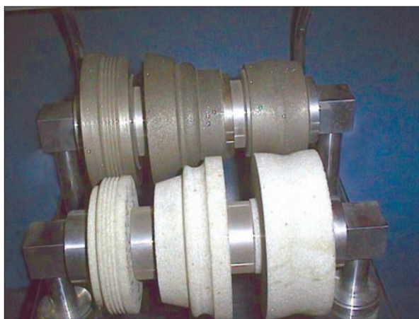
Рис. 5. Шліфування високоточного зубчастого колеса інструментами з кубічного нітриду бору (а); алмазні правлячі ролики (б)
