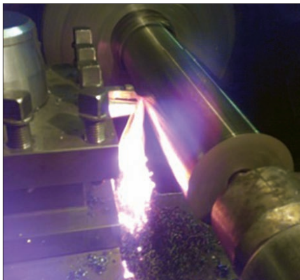
Рис. 2. Зона обробки виробу із загартованої сталі ШХ15 (62–64 HRC) інструментом із ПКНБ-VL; швидкість різання — 270 м/хв
