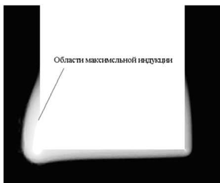
Рис. 8 – Индукция в магнитопроводе
