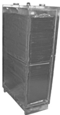
Рис. 8. Дополнительный нагрузочный конденсатор на 100 кВ емкостью 16,5 нФ
