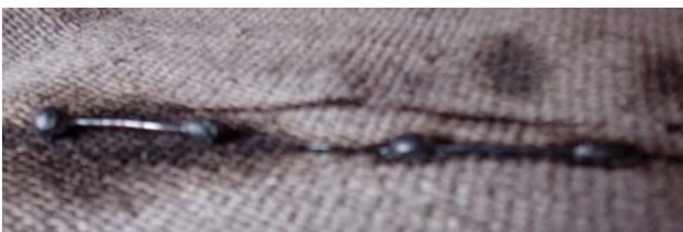
Рис. 7. Общий вид гантелеобразных элементов исследуемого оцинкованного стального провода, размещенных на теплоизолирующей асбестовой подложке, после их остывания на открытом воздухе
