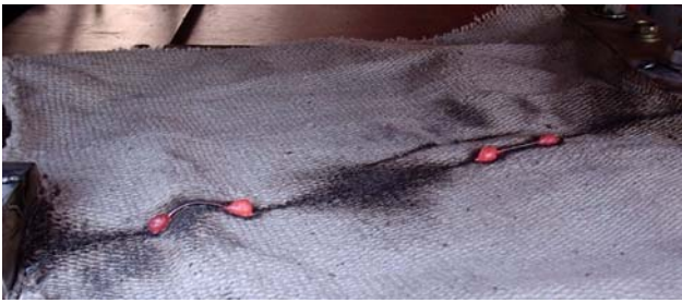
Рис. 6. Гантелеобразные элементы исследуемого оцинкованного стального провода на стадии остывания после их интенсивного нагрева мощным апериодическим импульсом тока проводимости i_n(t) большой плотности
