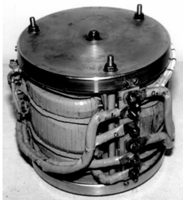
Рис. 5. Трехфазный компактный трансформатор с симметричным пространственным магнитопроводом мощностью 6,3 кВ·А (660/220/18 В, 50 Гц)
