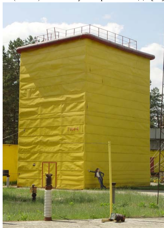
Рис. 5. Общий вид ГИН наружной установки на номинальное напряжение 4 МВ с запасаемой энергией в 1 МДж
