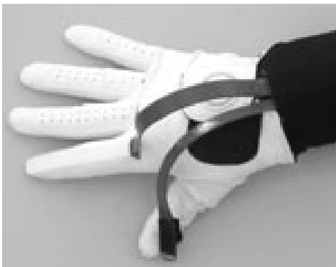
Рис. 11. Сенсорная перчатка, позволяющая ощущать объём поверхностей и их температуру
