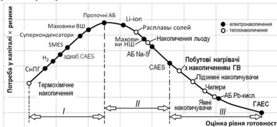
Рис. 4. Крива «зрілості», або розподіл технологій накопичення енергії в площині двох факторів – фактору «комерційно-технологічної зрілості» (вздовж осі «Оцінка рівня готовності») та фактору капітальних витрат і ризиків (вісь ординат), за [16-17, 19-20]:
