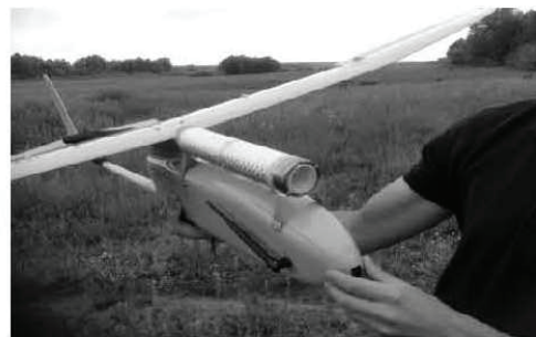
Рис. 5. Фото ФЕП, встановленого на БПЛА.
