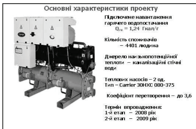
Рис. 4. Теплонасосна система гарячого водопостачання потужністю 1,5 кВт у м. Краматорськ.
